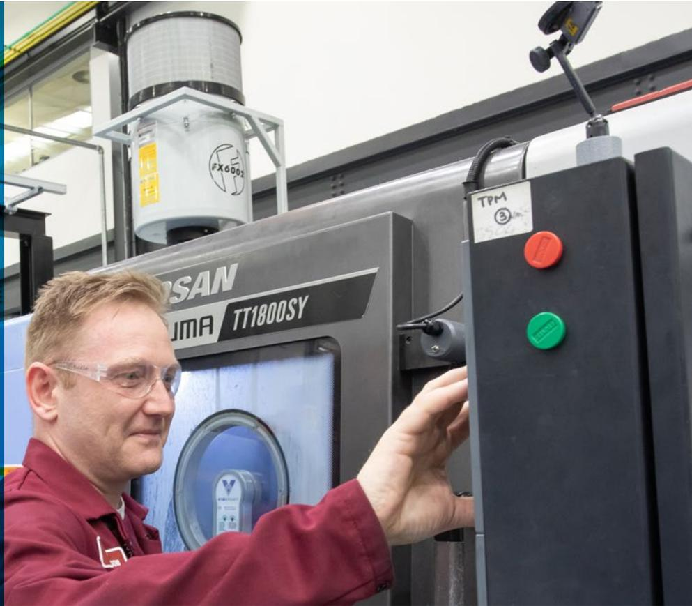
Der **F Monitor Essential** misst mit Hilfe des Druckverlustes den Luftstrom der Filteranlage. Durch ein einfach erkennbares Ampelsystem wird dem Maschinenbediener signalisiert, ob die Filteranlage problemlos arbeitet.
